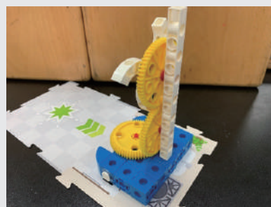
自製機關 - 風車示意圖 (可自行改裝，但須透過機器人中央齒輪來帶動風車)
